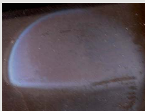
Fot. 9. Wyroszenie związków lotnych na próbce C (poliuretan 1)
