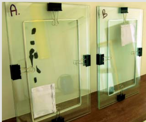
Fot. 6. Próbkę mas uszczelniających, zamknięte w przestrzeni międzyszybowej specjalnie przygotowanych próbek
