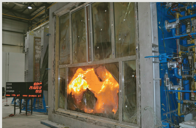
Fot. 1. Widok przeszklonej ściany osłonowej podczas badania odporności ogniowej
