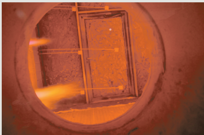
Fot. 3. Widok przeszklonych drzwi przeciwpożarowych od wewnątrz pieca, podczas badania odporności ogniowej
