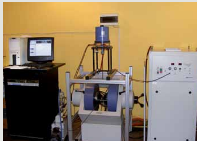
Rys. 2. Stanowisko do pomiaru podatności magnetycznej.
