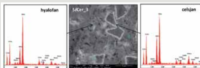
Rys. 13. Obrazy SEM-EDS tworzywa SzCer_3 wypalonego w temperaturze 1200 °C.
