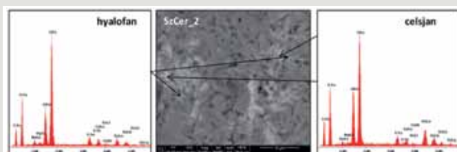
Rys. 9. Obrazy SEM-EDS tworzywa SzCer_2 wypalonego w temperaturze 1190 °C.
