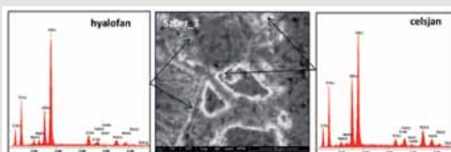
Rys. 14. Obrazy SEM-EDS tworzywa SzCer_3 wypalonego w temperaturze 1210 °C.
