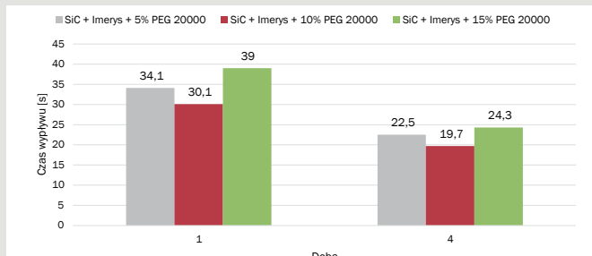
Rys. 6. Wpływ ilości PGE 20000 na lepkość względną mas w pierwszej i ostatniej dobie pomiarów.
