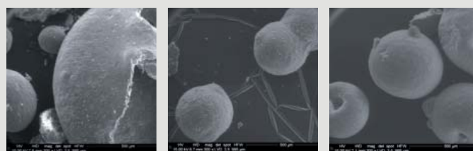
Rys. 3. Typowe defekty granulatu z suszarni rozpyłowych (Izak, Serkowski, 2011)
